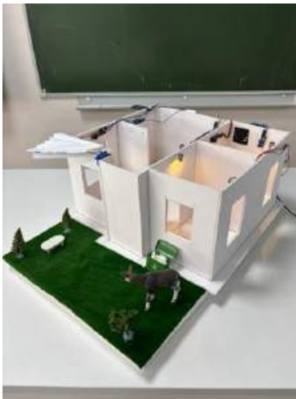
2-сурет – Arduino UNO платформасы негізінде құрастырылған көпфункционалды смарт-үй моделі
