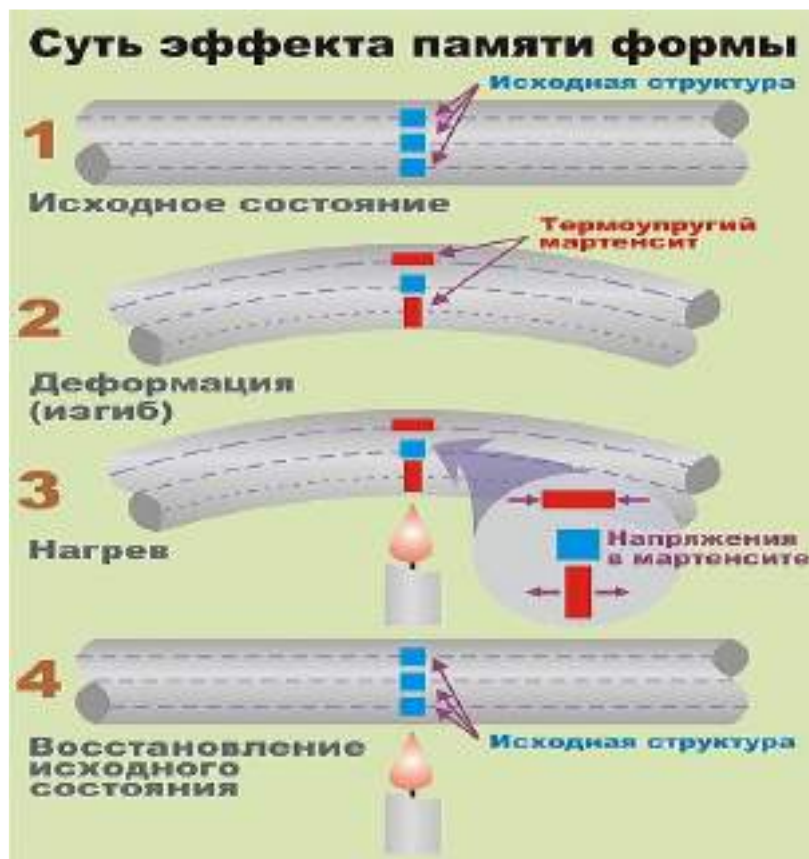
Рисунок 1 – Принцип работы материала с памятью формы (деформация → нагрев → восстановление формы)
