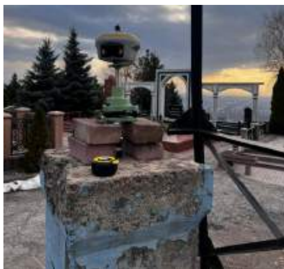
Рисунок 1 – Установка приемника ГНСС на пункте ГГС
