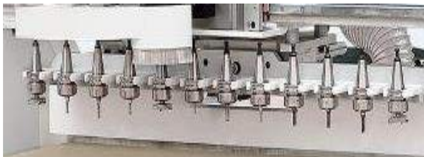
3-сурет –Құралды автоматты ауыстыру жүйесі
