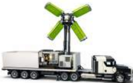
Рисунок 1 – Автономная передвижная электростанция с выдвижной мачтой
