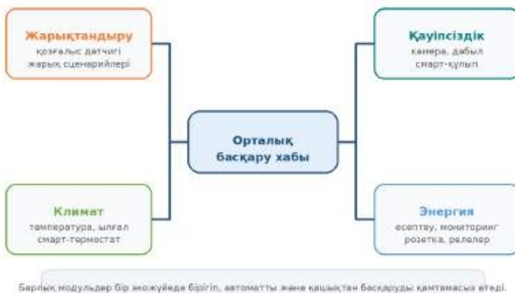
1-сурет – Ақылды үйдің құрылымдық сұлбасы
