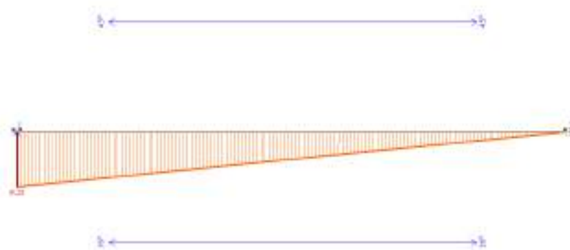
Рисунок 5 – Эпюра поперечной силы Q , для случая б).
