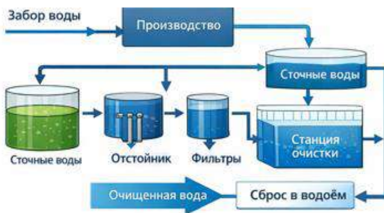
Рисунок 2 – Обратная система водоснабжения на предприятии.
