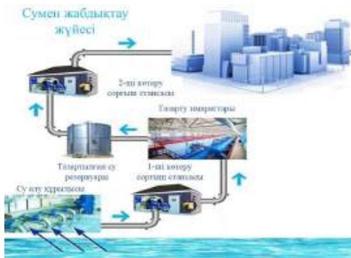
1-сурет – Сумен жабдықтау жүйесінің қалаға тарату қарапайым сұлбасы.
