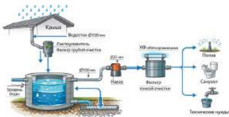
Рисунок 4 – Гидравлическая схема системы сбора и использования дождевой воды.
