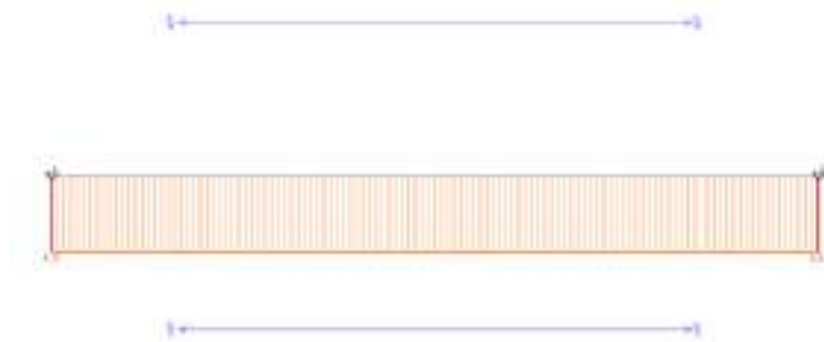
Рисунок 3 – Эпюра изгибающего момента M , для случая а).
