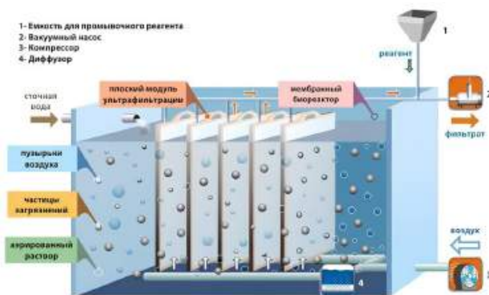
Рисунок 2 – Принципиальная схема работы мембранного биореактора.
