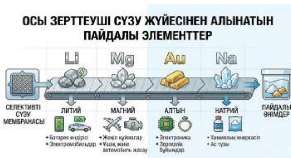
6-сурет – Рапаны айналмалы кәдеге жарату және минералдарды бөліп алу процесі.
