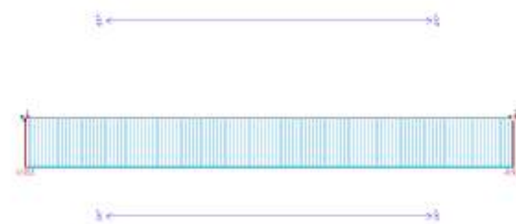
Рисунок 5 – Эпюра поперечной силы Q , для случая б).
