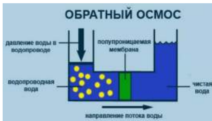
Рисунок 1 – Метод обратного осмоса.
