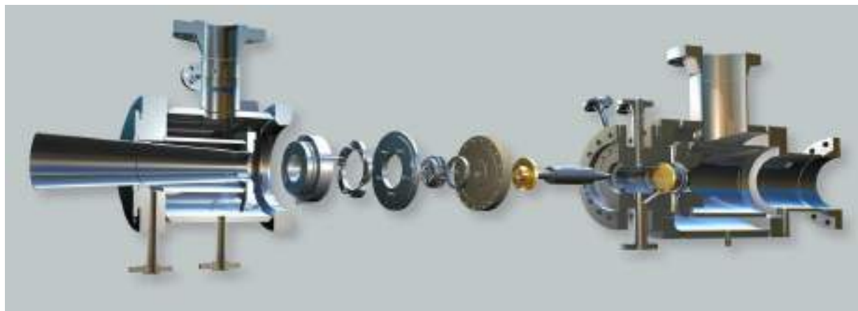
Рисунок 1 – Конструктивная схема турбодетандерной установки для производства сжиженного природного газа (СПГ).
