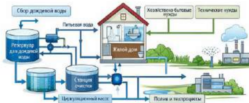
Рисунок 3 – Комбинированная система водопользования.
