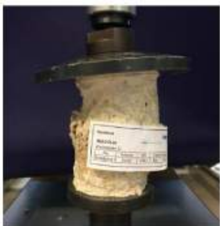
3-сурет – Әртүрлі материал тығыздығы үшін бағаланған сығылу беріктігі
