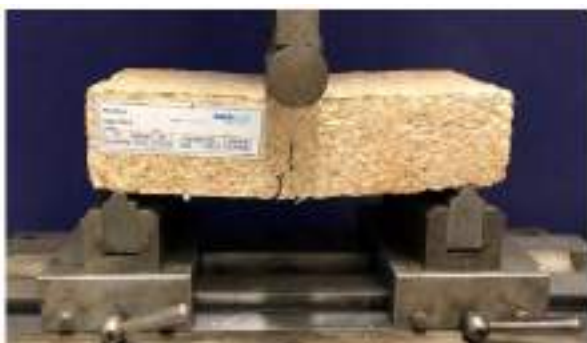
4-сурет – Сол жақта: үш нүктелі иілу сынақтары орнатылған; оң жақта: тығыздығы 0,5 г/см 3 (қара), 0,6 г/см 3 (қызыл) толтырылған үлгілердің күш ығысу қисықтары
