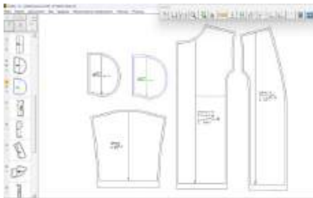
Рисунок 4 – Построение чертежа конструкции и лекал (основных и производных) пальто в САПР Gerber
