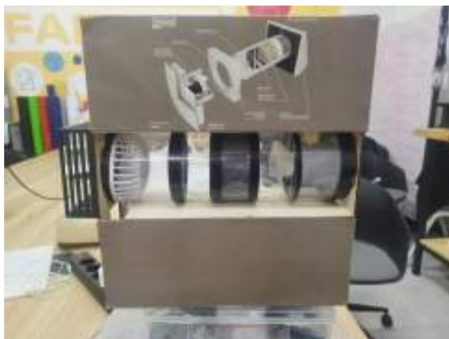
Рисунок 2 – Макет установки для исследования фотокаталитической очистки воздуха
