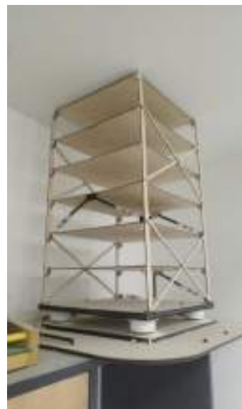
Рисунок 1 – Экспериментальный макет сейсмоплатформы с демпферными элементами
