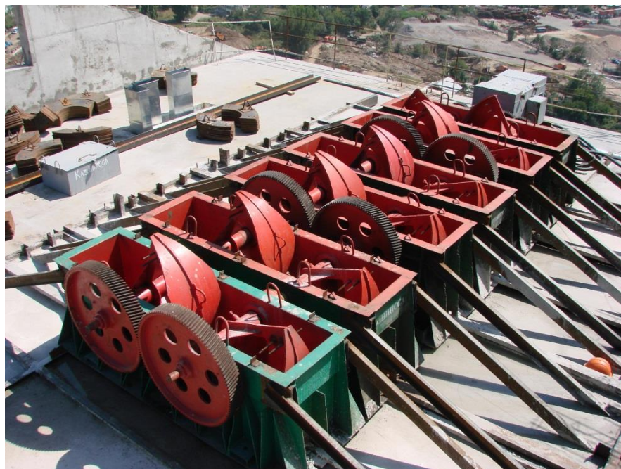
Рисунок 17 – Внешний вид вибрационной машины, установленной на перекрытии
