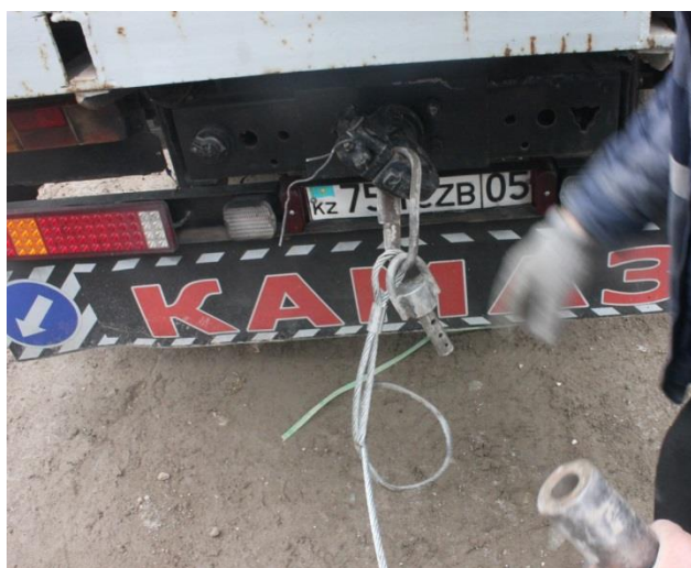
Рисунок 28 – Вставка соединения троса с силовой установкой (автомашина)
