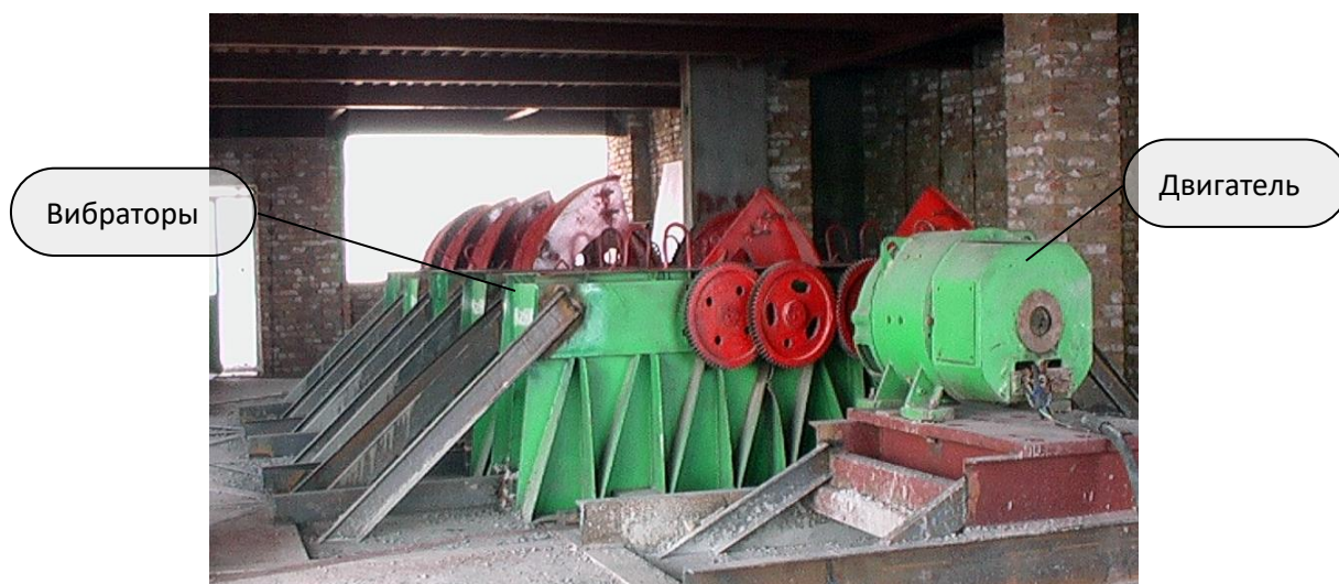
Рисунок 11 – Вибромашина инерционного действия типа В-3
