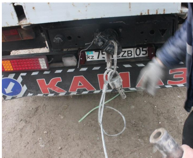
Рисунок 28 – Вставка соединения троса с силовой установкой (автомашина)
