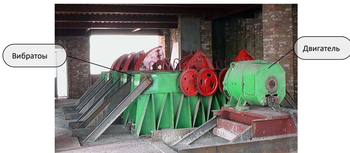
Рисунок 10 – Вибромашина инерционного действия типа В-3
