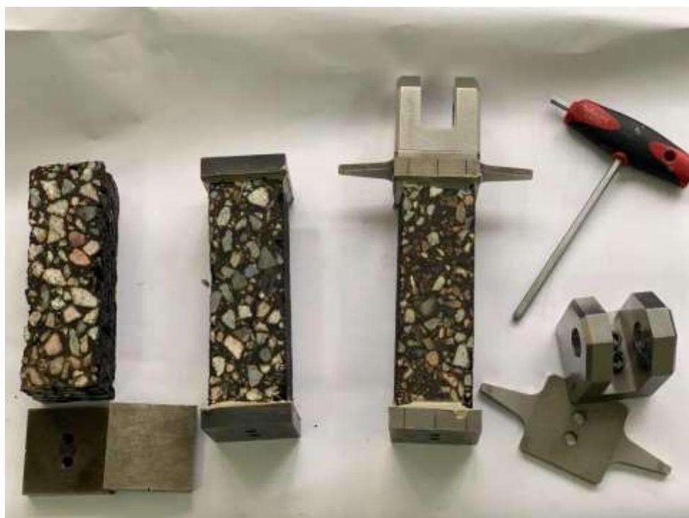
Рисунок 35 - Поэтапная подготовка образца асфальтобетона к испытанию
