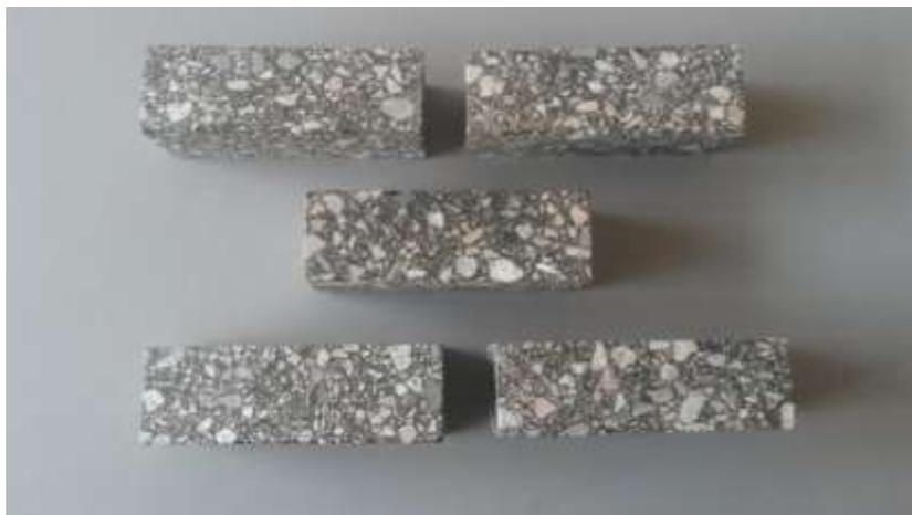
Рисунок 30 - Образцы для испытания по определению низкотемпературного трещинообразования
