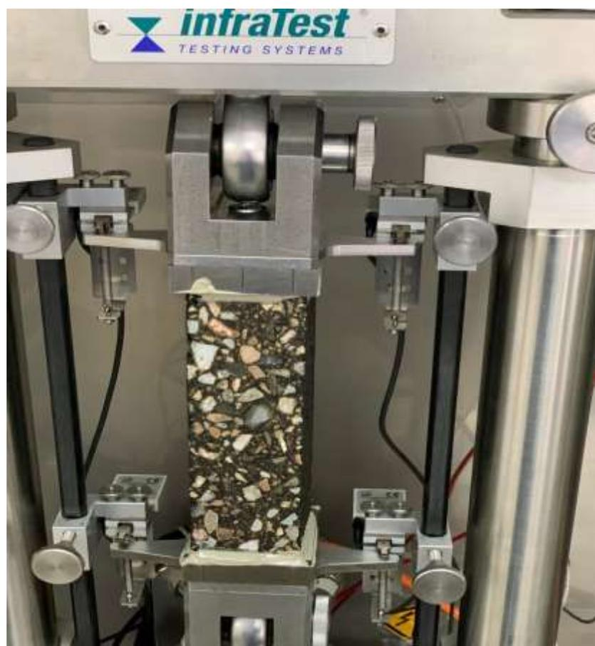
Рисунок 43 - Установленный образец для испытания
