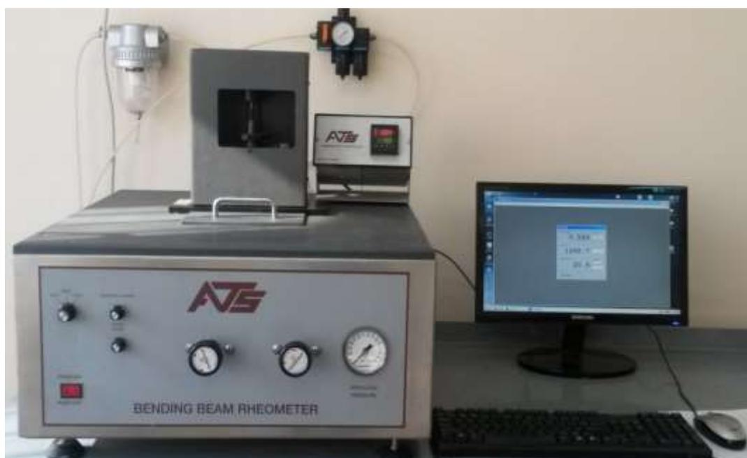
Рисунок 24 - Реометр с изгибающейся балкой (BBR)
