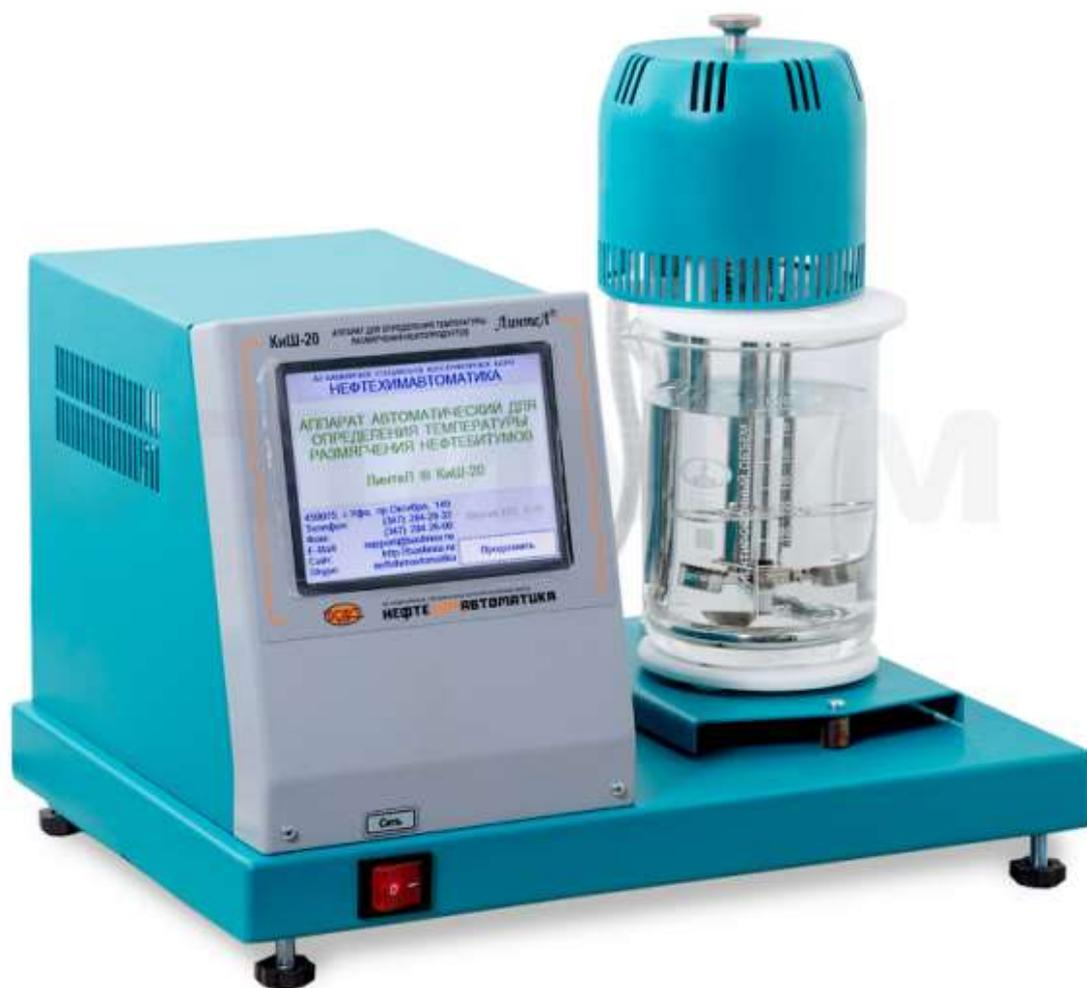
Рисунок 2 - Аппарат автоматический «ЛинтеЛ КиШ-20» для определения температуры размягчения нефтебитумов
