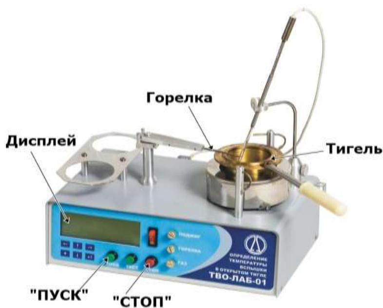
Рисунок 4 - Прибор для определения температуры вспышки в открытом тигле
