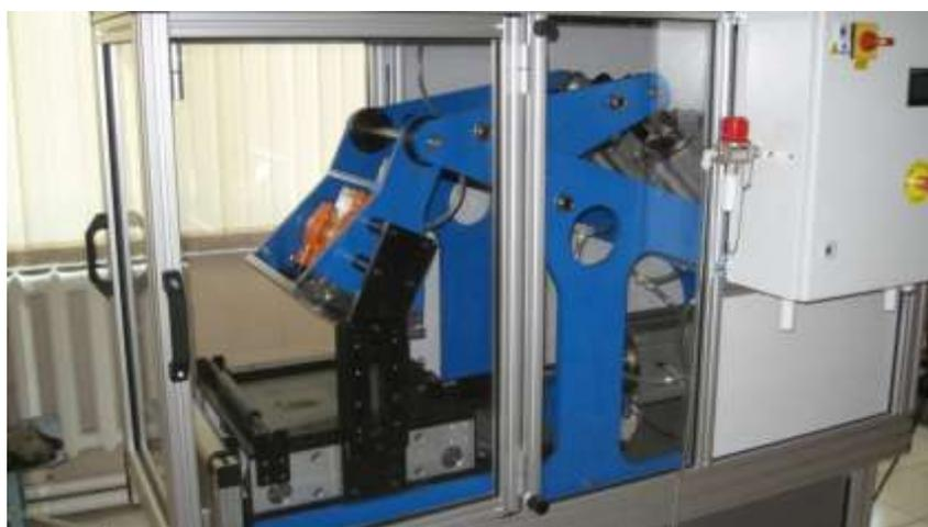
Рисунок 27 - Роллерный компактор CRT-RC2S
