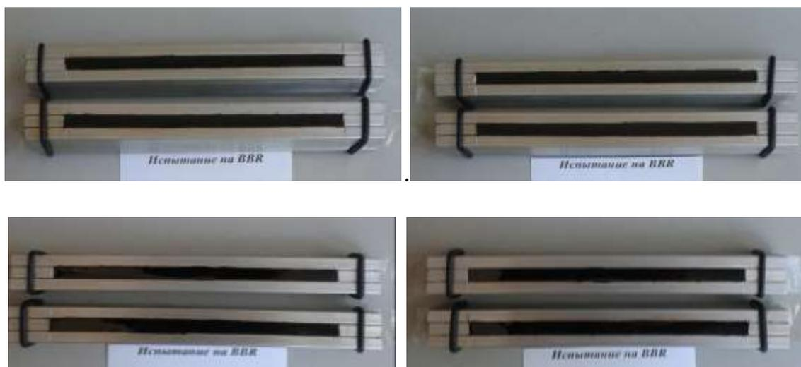
Рисунок 25 - Битумные балочки приготовленные для испытания
