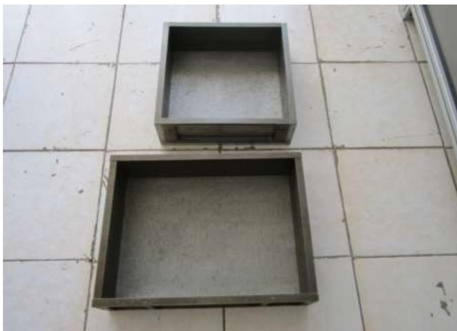
Рисунок 28 - Формы плит для изготовления асфальтобетонных образцов
