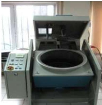
Рисунок 17 - Лабораторный лопастной смеситель объемом 30 литров
