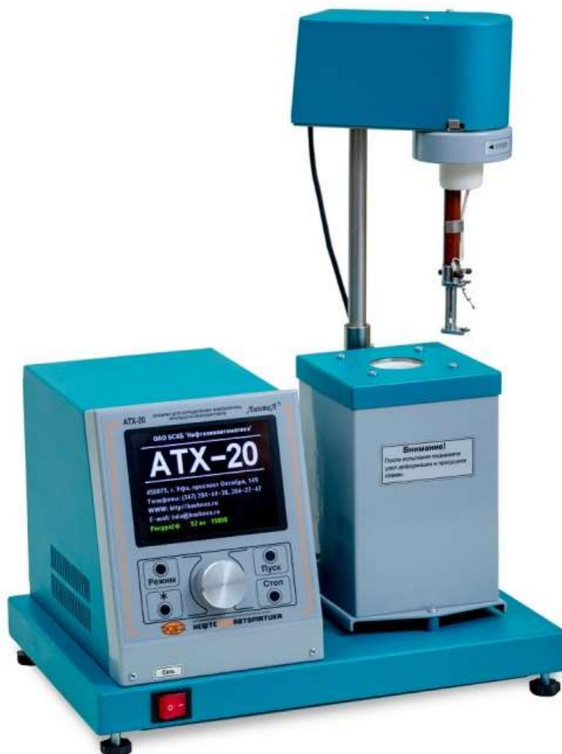
Рисунок 5 - Автоматический прибор для определения температуры хрупкости
