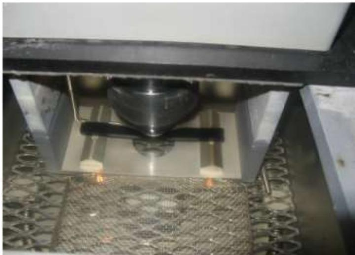
Рисунок 26 - Битумная балочка при испытании
