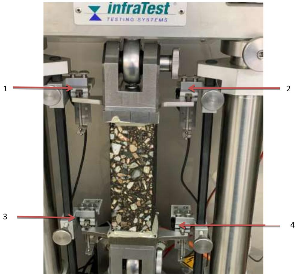
Рисунок 40 - Датчики перемещения
