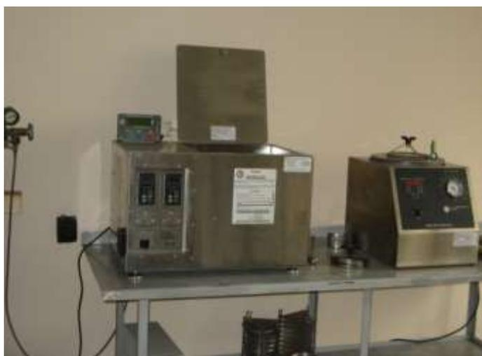
Рисунок 7 - Аппарат PAV
