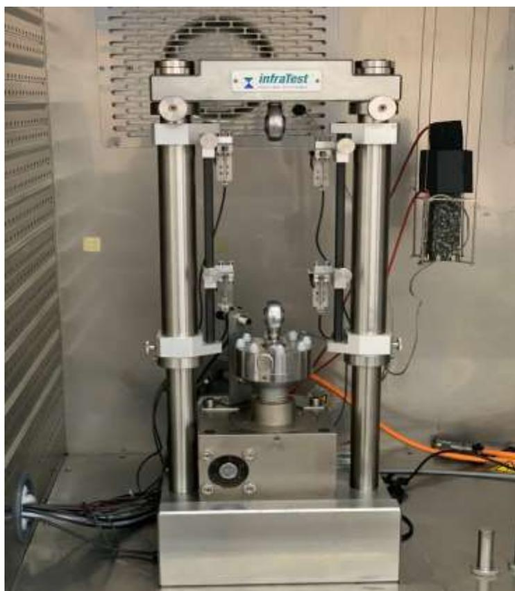
Рисунок 38 - Испытательный стенд с разрушающим устройством
