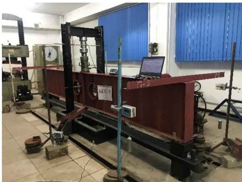
а) графики «нагрузка–перемещение» соответственно (1), (2) для компьютерных и экспериментальных данных; б) чертеж балки БГС–5; в) компьютерная модель балки БГС–5; г) общий вид установки для испытания балки БГС–5
