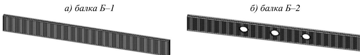
а) балка Б-1 с гофрированной стенкой без отверстий; б) балка Б-2 с гофрированной стенкой с тремя отверстиями
