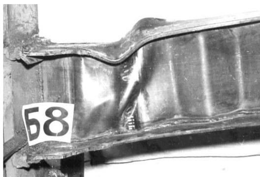
Рисунок 11 – Потеря местной устойчивости отдельных плоскостей гофров со сдвигом сжатого пояса [23 с.43]
