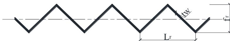
Рисунок 44 – Схема треугольного очертания, принятая при компьютерном моделировании
