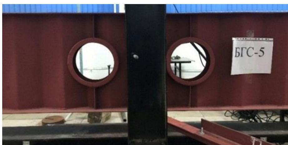
Рисунок 89 – Характер исчерпания несущей способности образца БГС–5 в виде небольшого пропелерообразного изгиба сжатого пояса
