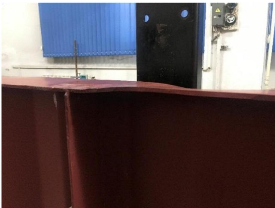
Рисунок 81 – Характер исчерпания несущей способности образца БГС-1 в виде потери местной устойчивости сжатого пояса
