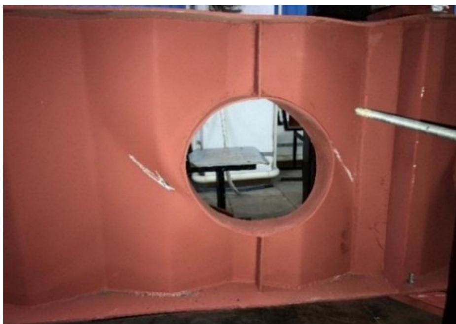
Рисунок 87 – Характер исчерпания несущей способности образца БГС–4 в виде потери местной устойчивости отдельных плоскостей гофров, пропелерообразный изгиб сжатого пояса и потеря его устойчивости, текучесть нижнего пояса, выгиб окаймления из плоскости стенки
