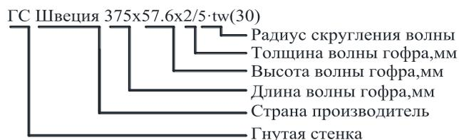
Рисунок 16 – Образец обозначения основных геометрических характеристик сечения
