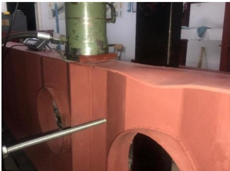
Рисунок 85 – Характер исчерпания несущей способности образца БГС–3 в виде потери местной устойчивости сжатого пояса
